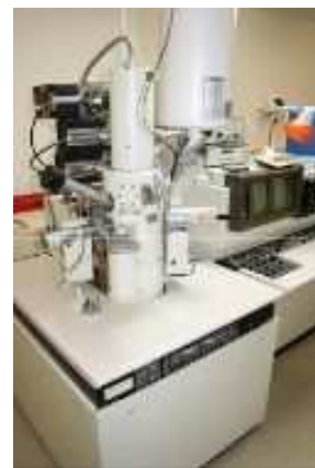
ナノの世界を広げる 走査型電子顕微鏡
