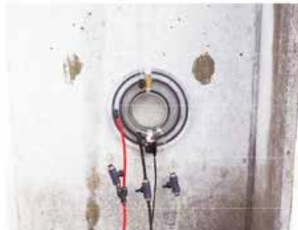
吸水試験による表層品質の評価
