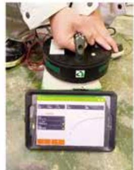
非破壊型鉄筋腐食度評価
