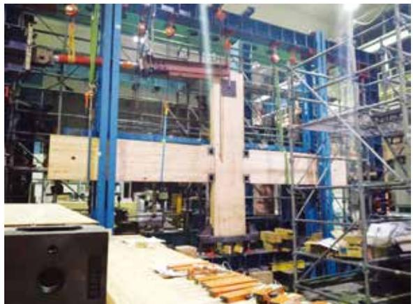
靱性型ホームコネクターを用いた4階建て木造ビルの柱-梁十字型ラーメン接合部の実験の様子
